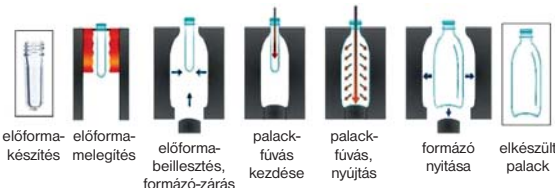
2. ábra. A PET palackok gyártási folyamata
